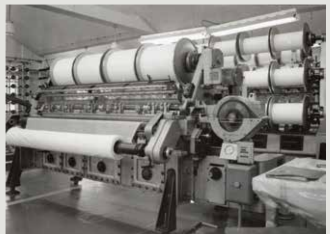
Izdelava pletiva za vezenje na snutkovnem stroju leta 1975 (Foto Drago Holylnski, Fototeka Gorenjskega muzeja)
